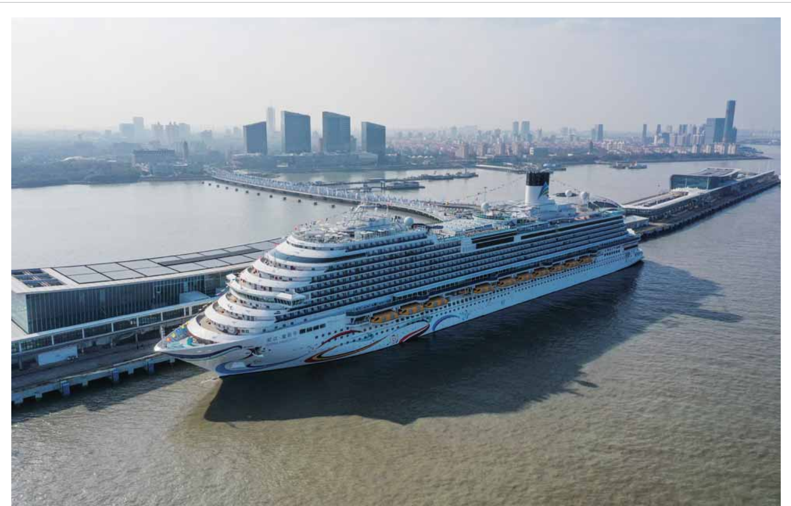
1 月 1 日，“爱达·魔都号”停靠在上海吴淞口国际邮轮港（无人机照片）。当日，国产首艘大型邮轮“爱达·魔都号”在上海吴淞口国际邮轮港正式开启商业首航。“爱达·魔都号”是一座“海上现代化城市”，也是一项巨系统工程：总吨位 13.55 万吨，长 323.6 米，宽 37.2 米，最大高度 72.2 米；船上有客房 2125 间，可容纳乘客 5246 人，配置高达 16 层、面积 4 万平方米的生活娱乐公共区域。 ■新华社发
