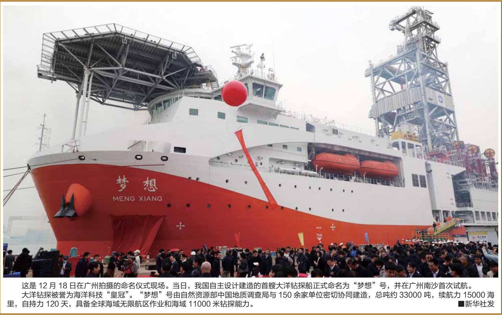
这是12月18日在广州拍摄的命名仪式现场。当日，我国自主设计建造的首艘大洋钻探船正式命名为“梦想”号，并在广州南沙首次试航。大洋钻探被誉为海洋科技“皇冠”。“梦想”号由自然资源部中国地质调查局与150余家单位密切协同建造，总吨约33000吨，续航力15000海里，自持力120天，具备全球海域无限航区作业和海域11000米钻探能力。■新华社发
