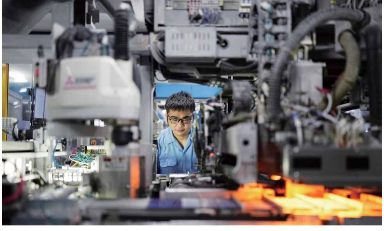
8月9日，在台州市黄岩区省级专精特新“小巨人”企业浙江公元新能源科技股份有限公司，工作人员操作全自动焊接机生产太阳能电池片。
