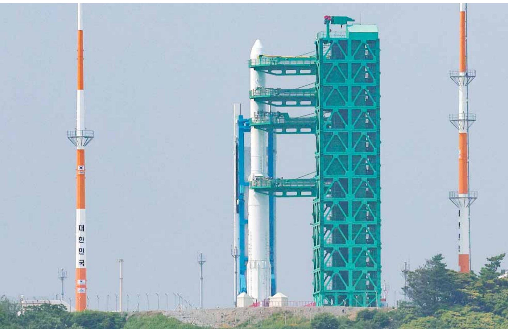
5月24日，在韩国高兴郡的罗老宇航中心，“世界”号火箭停放在发射台上。韩国自主研制的火箭“世界”号24日在预定发射时间前数小时出现技术问题，发射被迫取消。“世界”号是三级运载火箭，总重200吨，可将1.5吨级卫星送至距离地面600至800公里的轨道。 ■新华社发
