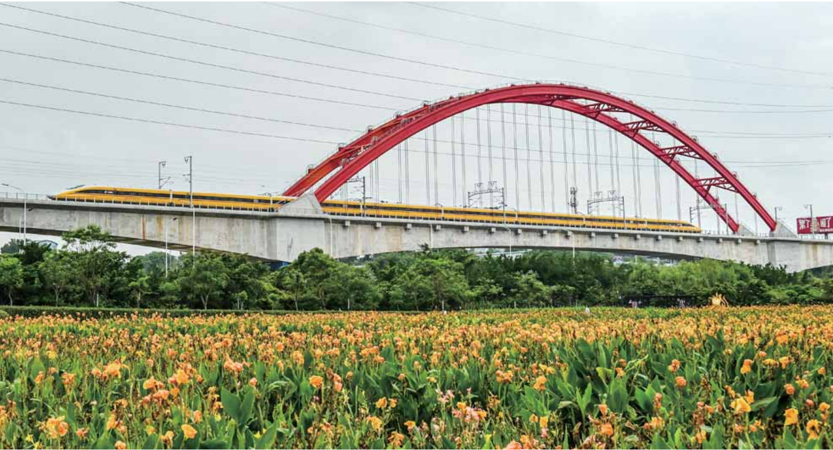
5月16日,高速综合检测列车行驶在贵南高铁上进行检测工作。当日,CRH380AJ-0203高速综合检测列车对贵南高铁全线进行逐级提速试验,以时速180公里的速度级,对南宁东至荔波站区间高铁沿线的轨道、信号、通信、电务、综合接地等多个项目进行检测。列车因车身涂装成醒目的黄色,又被称为“黄医生”。
