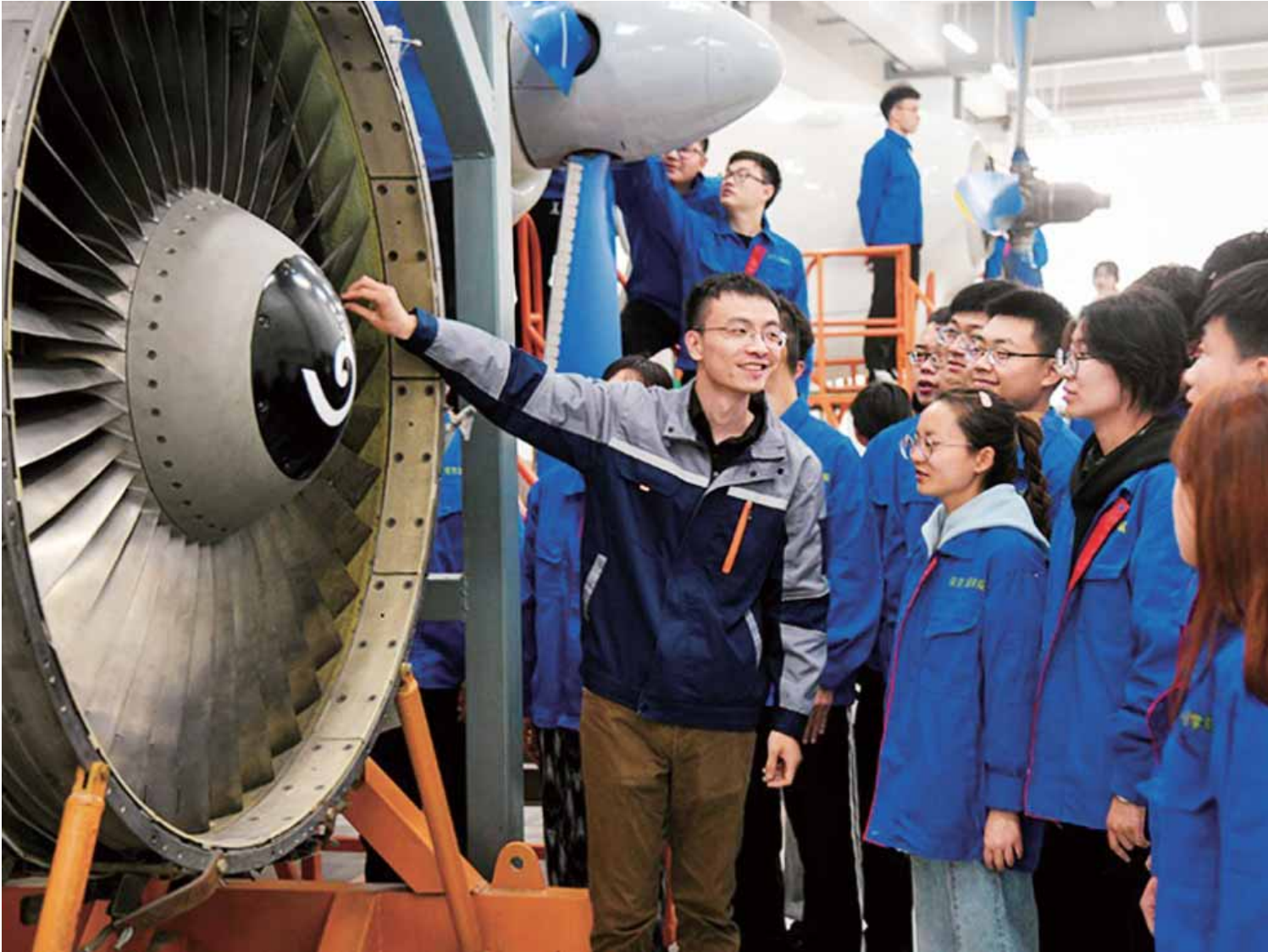
南京工业职业技术大学飞机电子设备维修专业徐白讲师（左一）给学生讲解CFM56航空发动机的检修注意事项（2021年4月21日摄）。 ■南京工业职业技术大学供图
