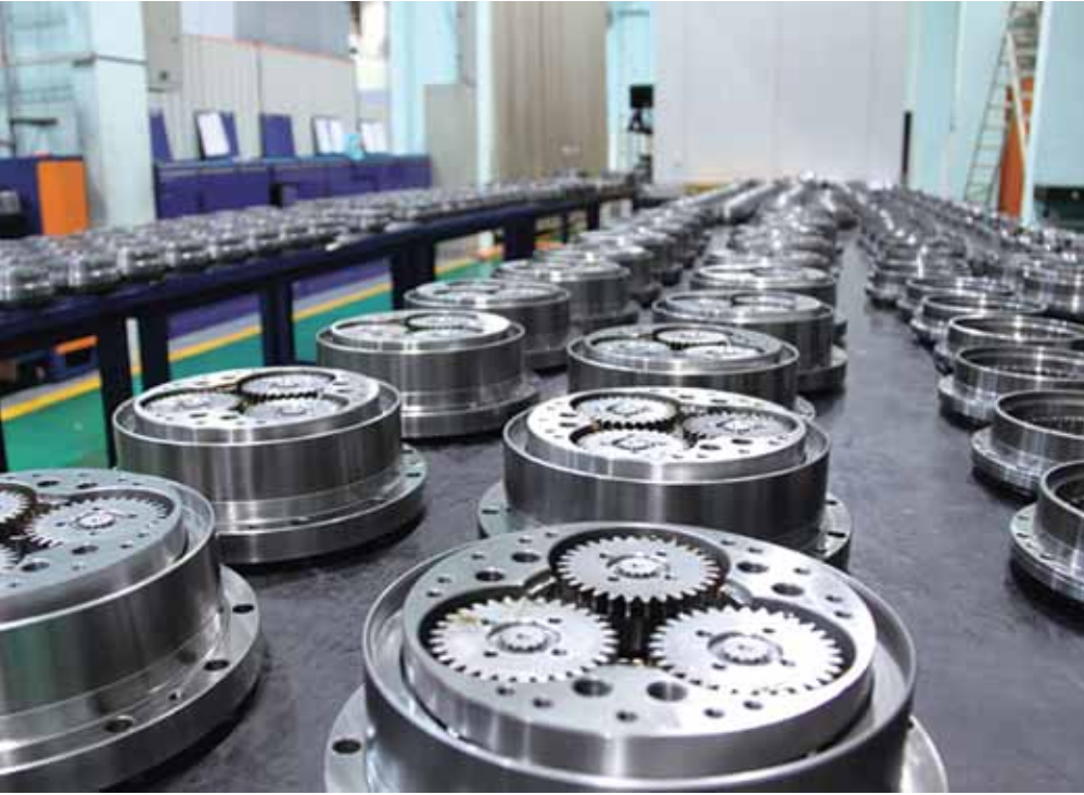
秦川机床生产的工业机器人RV减速机（2023年4月19日摄）。■受访者供图
