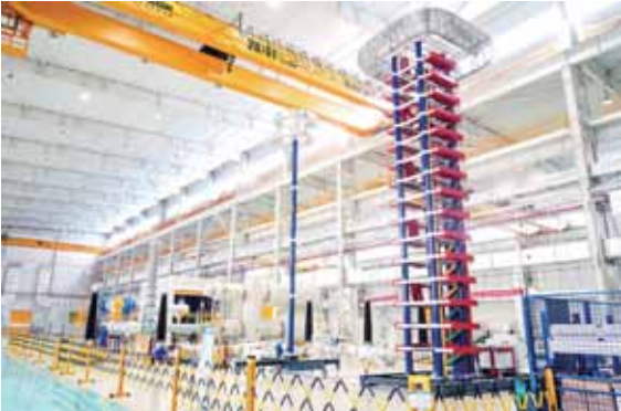
行业领先检测试验设备——雷电冲击发生器。
