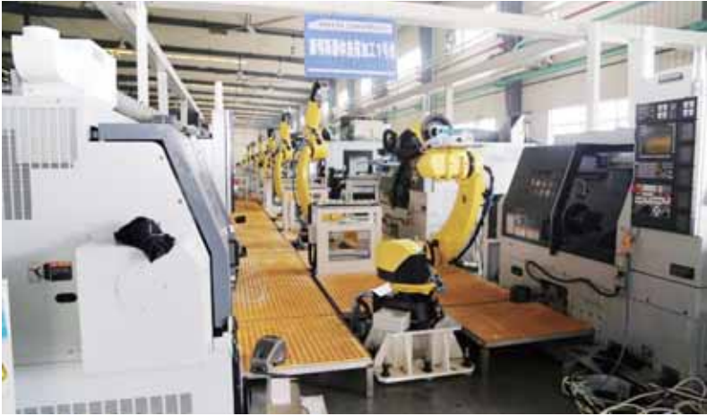
南岳电控数字车间，一排排机器人手臂上岗作业。
