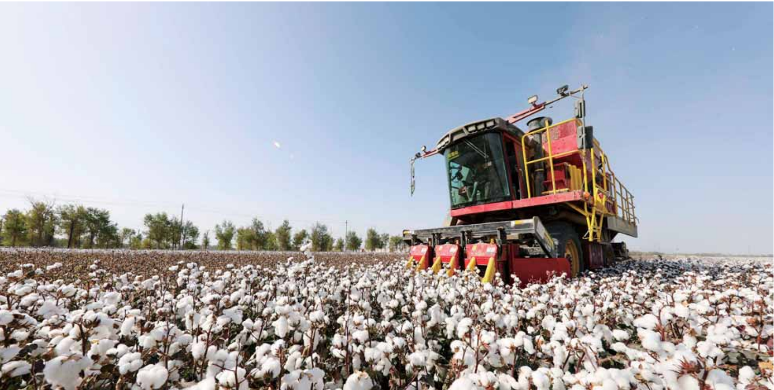
在新疆巴音郭楞蒙古自治州尉犁县兴平镇巴西阿瓦提村的一块棉田里,国产采棉机在采收棉花(10月14日摄)。10月是新疆棉花采收工作最繁忙的阶段,一台台采棉机穿梭在棉海中,场面蔚为壮观。据新疆农业农村厅数据显示,预计2022年新疆(不含新疆生产建设兵团)棉花机采率超过80%。近年来,国内一些大型农机制造企业投身采棉机研发制造,国产三行、六行圆捆打包采棉机已成为新疆棉田里的重要帮手。 ■新华社发
