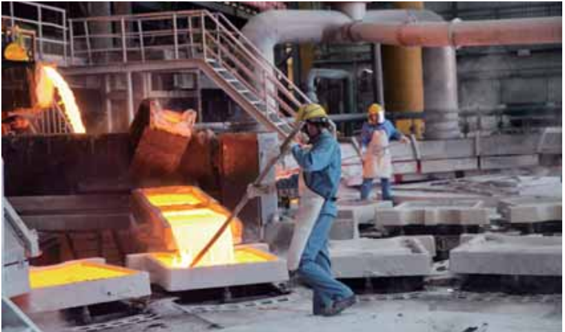
操作人员正在进行圆盘浇铸作业。
