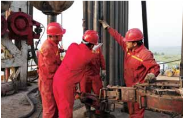
大口径快速扣套管安装现场。
