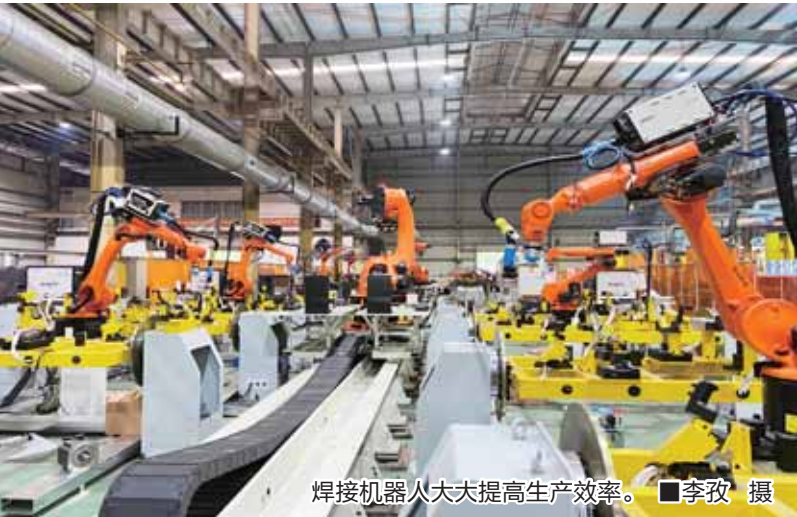
焊接机器人大大提高生产效率。■李孜 摄
