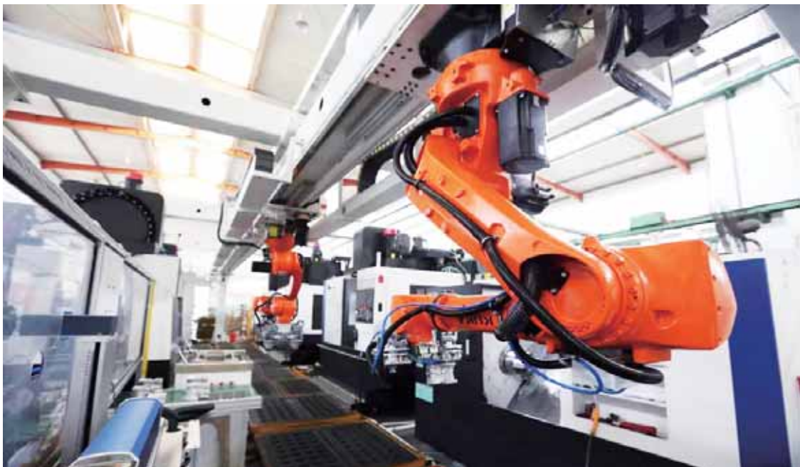
南岳电控铝件车间共轨泵自动加工线。
