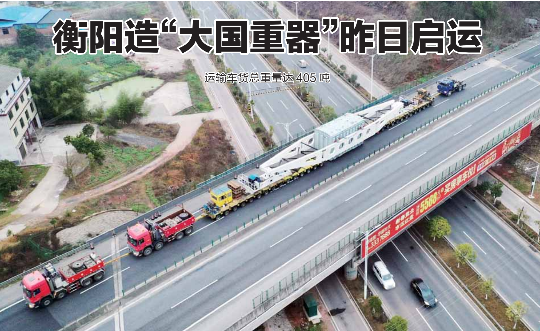
衡阳造“大国重器”昨日启运 运输车货总重量达 405 吨 1000MVA/1000kV 变压器由 3 台大功率牵引车辆牵引。
