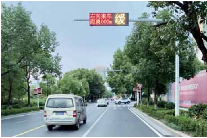
“道路安全预警系统”最远可监控200米内来车。
