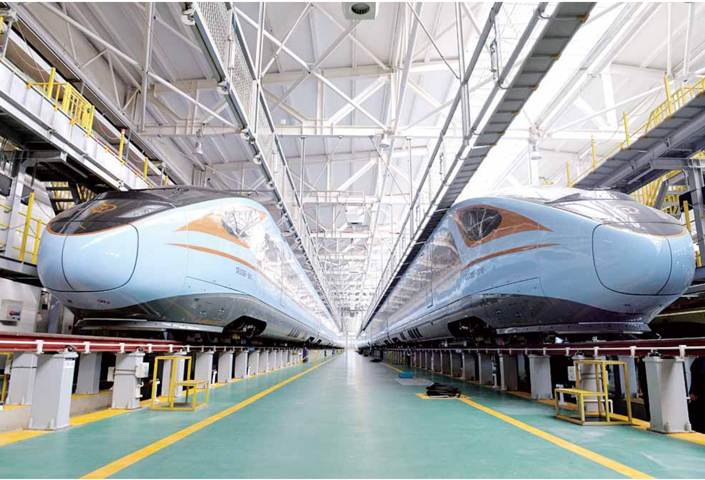
这是 12 月 23 日在中国铁路兰州局集团有限公司兰州车辆段银川动车运用所拍摄的 CR300BF 型“复兴号”动车组。日前，共计三组 CR300BF 型“复兴号”动车组抵达银川，担负即将开通的银西高铁旅客运输任务。据了解，CR300BF 型“复兴号”动车组，是中国标准动车组系列化产品之一，设计最高运营时速 250 公里。
