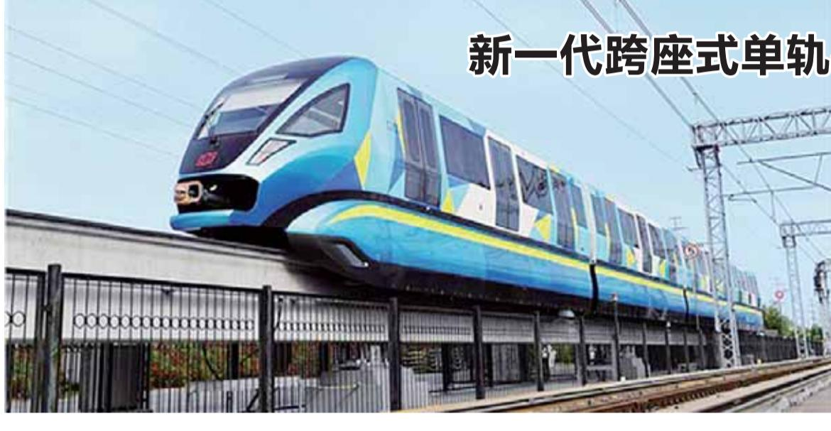
日前，由中车四方股份公司研制的新一代跨座式单轨列车在试验线上成功试跑。该车具有完全自主知识产权，国产化率达95%以上。车辆最高运行速度为100公里/小时，是目前国内速度等级最高的跨座式单轨列车。该车兼具地铁与单轨列车技术优势，标志着我国在跨座式单轨车辆技术领域取得重大突破。
