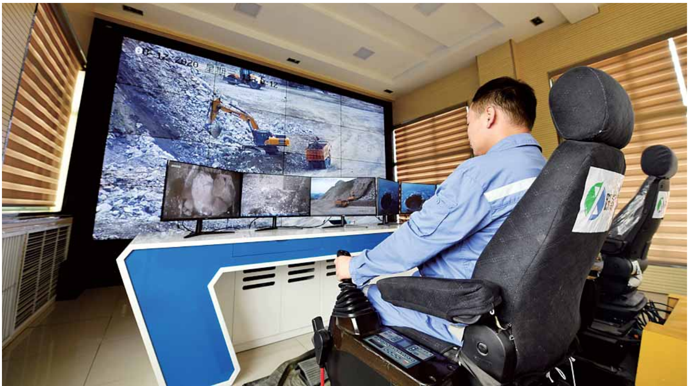
工人在洛阳钼业三道庄露天矿智能调度中心远程遥控挖掘机作业
