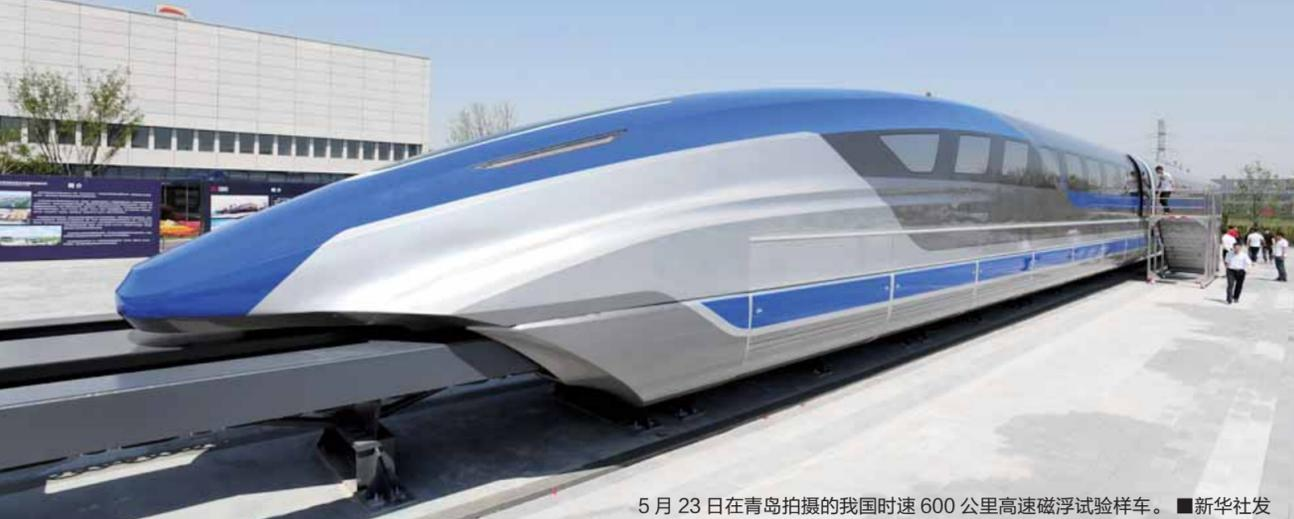
5月23日在青岛拍摄的我国时速600公里高速磁浮试验样车。■新华社发
