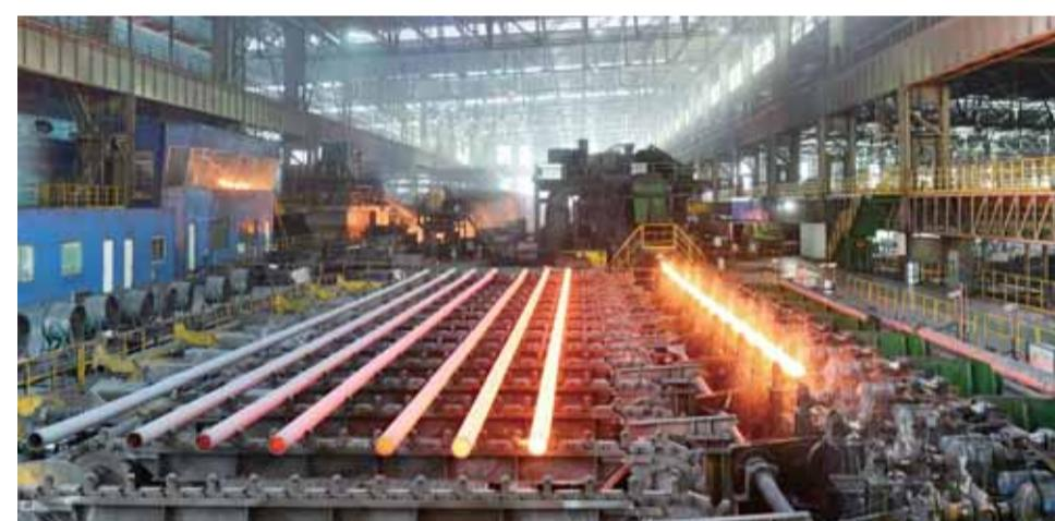
华菱衡钢无缝钢管生产现场
