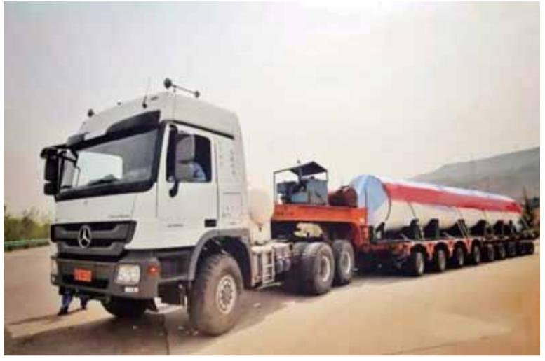
完成组装的3段式2米直径固体助推器
