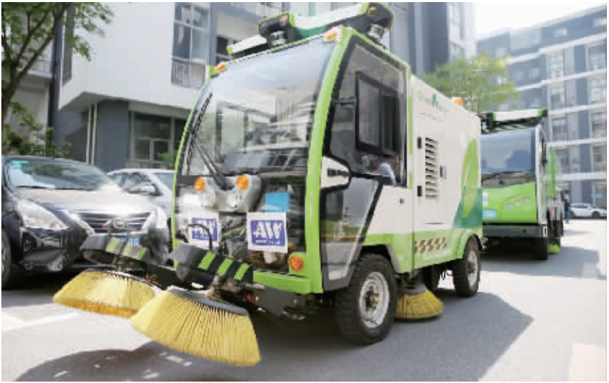
近日,无人驾驶清扫车队亮相上海市松江区,并在上海启迪漕河泾(中山)科技园试运营。该车队由一辆6米长的中型清扫车以及一辆3米长的小型清扫车组成,可自动启动、自动清扫、自动通过红绿灯、自动避开路边障碍等。
