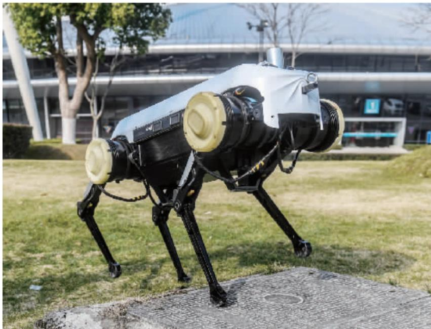
2 月 11 日，在浙大紫金港校区，四足机器人正在跨越地面障碍。近日，浙江大学的机器人研发团队发布了“绝影”四足机器人。该机器人身长 1 米，四足站立时 60 厘米高，重 70 千克，载重可达到 20 公斤，行走速度为每小时 6 公里，续航时间 2 小时。目前，“绝影”四足机器人已经掌握了跑跳、爬梯子、在碎石子路上行走、自主蹲下再站起来等许多能力，即使摔倒在地，也能够自动调整身体方位重新站立，有望在安防、侦查、救灾等实际场景中应用。 ■新华社发
