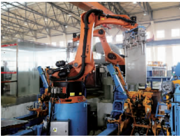
衡阳工业门类齐全、基础雄厚。图为电解阴极剥片机组正在进行剥片。
