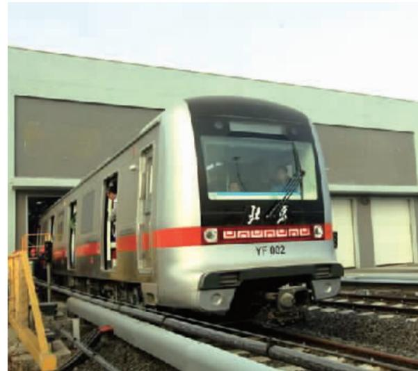
地铁燕房线热滑试验
