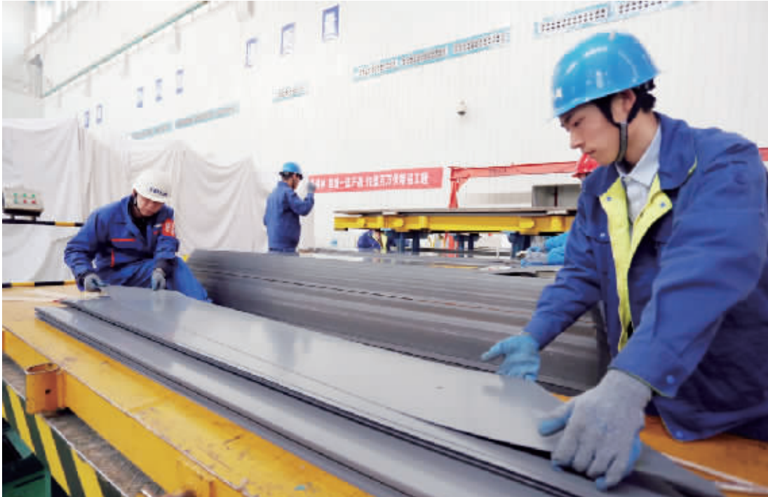
特变电工工人正在叠放硅钢片
