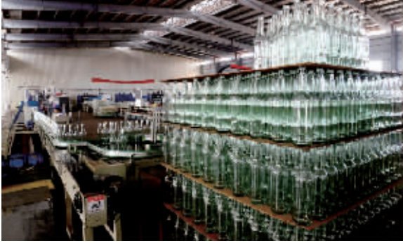
华亚玻璃公司采用全自动验瓶机和全自动包装线，大大提高了生产效率
