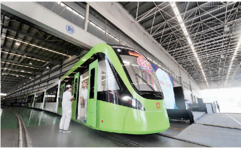
8月1日,中国首列完全自主化全线无接触网“超级电容”现代有轨电车在中车株洲电力机车有限公司下线。据中车株机总工程师索建国介绍,这款城市电车具有三大比较优势。一是甩掉了“大辫子”,全程无架空接触网运行,消除了“视觉污染”;二是以9500法拉“超级电容”储能供电,车辆在站台区30秒内快速完成充电,一次可运行3至5公里;三是该车制动时能将85%以上的制动能量回收反馈至超级电容形成电能储存,实现能量循环利用。
