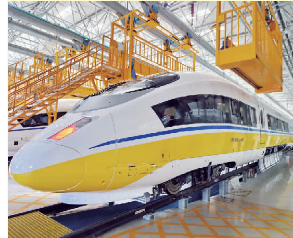
3 月 31 日，国内首款能够适应高寒地区检测需求的“高铁医生”——时速 350 公里高寒综合检测列车在中车长春轨道客车股份有限公司下线，即将前往中国铁道科学研究院环铁试验线进行整车型式试验。该车基于 CRH380BG 型高寒动车组平台研制，能够实时检测基础设施和车辆高速行驶的技术参数，为线路日常维护提供指导和数据支撑。同时，为了满足检测人员生活、工作需求，车辆内装进行了大量改动，设置了工作车、餐车、卧铺车、会议室。图为在中车长客高速动车组制造中心，高寒综合检测列车等待验收。
