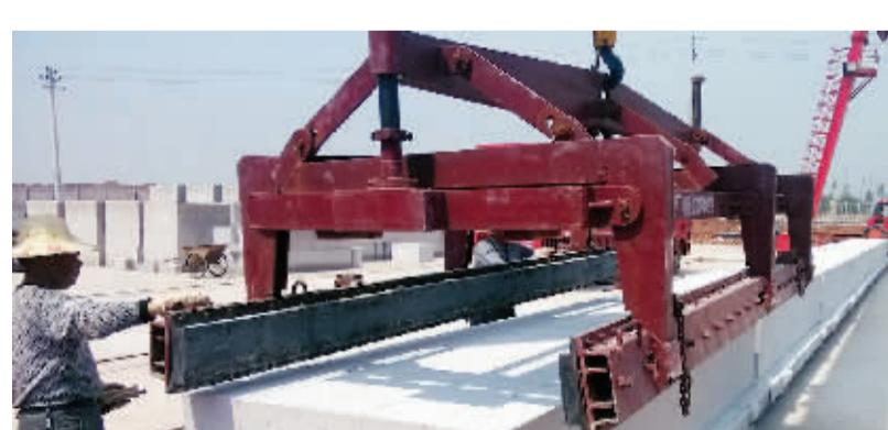
图为在堆料场,工人正指挥龙门吊将一批刚出炉的加气块砖成品码放整齐。
