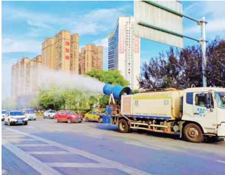
多功能抑尘车喷射水雾,吸热降温。
