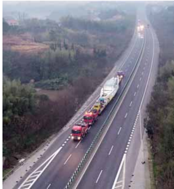
衡阳造“巨无霸”需用3台大型车辆牵引、推动。
