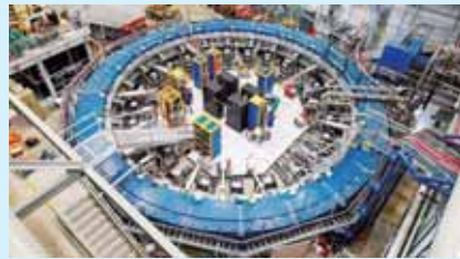
在美国费米国家加速器实验室的这个环内,缪子像指南针一样在磁场中旋转,精确度为十亿分之三十。
