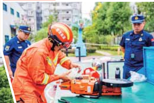
消防装备维护员正在组装双轮异向切割锯。
