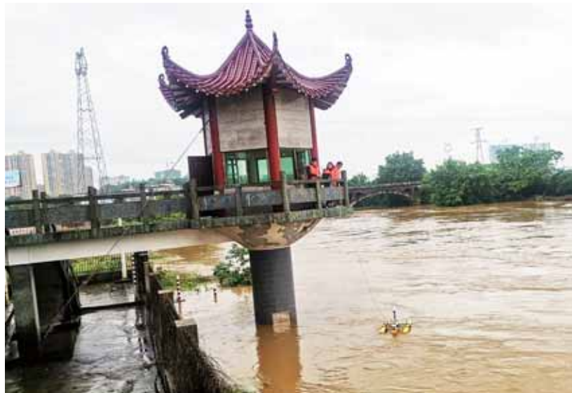
水文站工作人员在洪水中投放仪器,进行流量测验。
