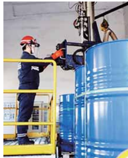
2 月 18 日,在位于山东省滨州市博兴经济开发区的外资企业诺力昂化学品(博兴)有限公司,工人正使用自动灌装设备灌装甘油产品。
