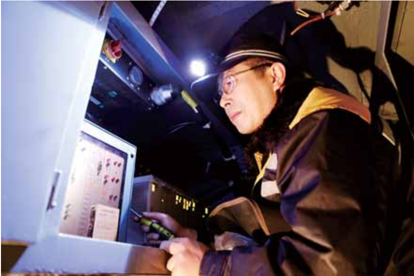
技术人员检查“黑匣子”STP 主机板件各指示灯显示是否正常
