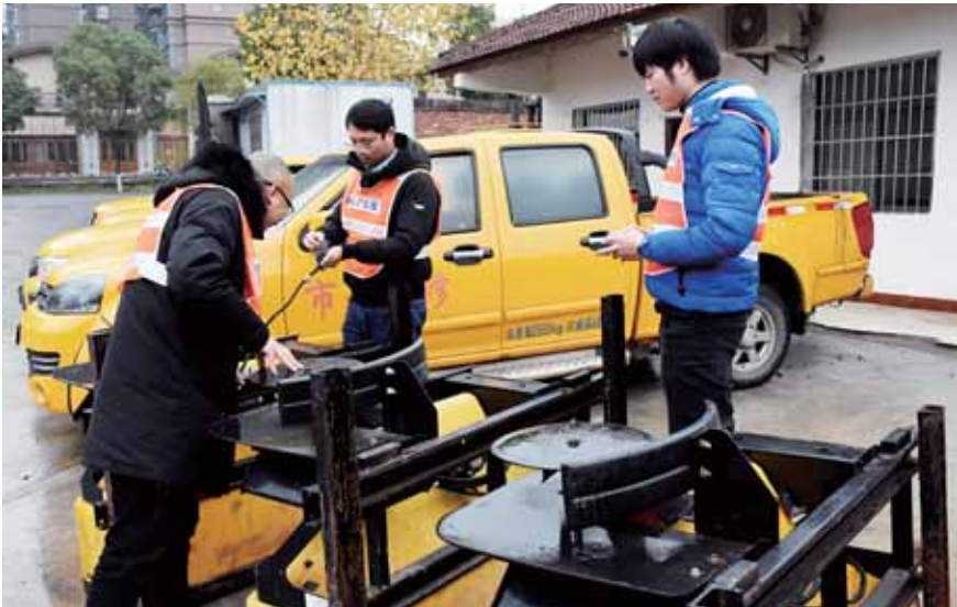
技术人员检查调试融雪剂撒布机等设备
