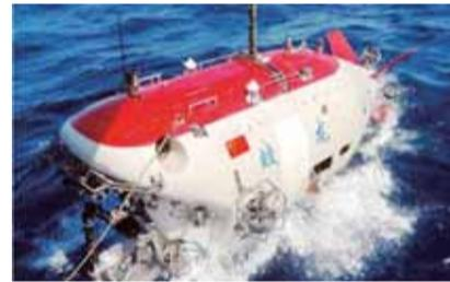
中国第一台自主设计和集成研制的载人潜水器“蛟龙”号下潜深度达到了3759米,中国成为继美、法、俄、日之后,世界上第五个掌握3500米大深度载人深潜技术的国家。
