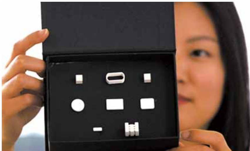
中国新一代载人飞船试验船在轨运行期间利用立体光刻3D打印技术成功制造的8件样品
