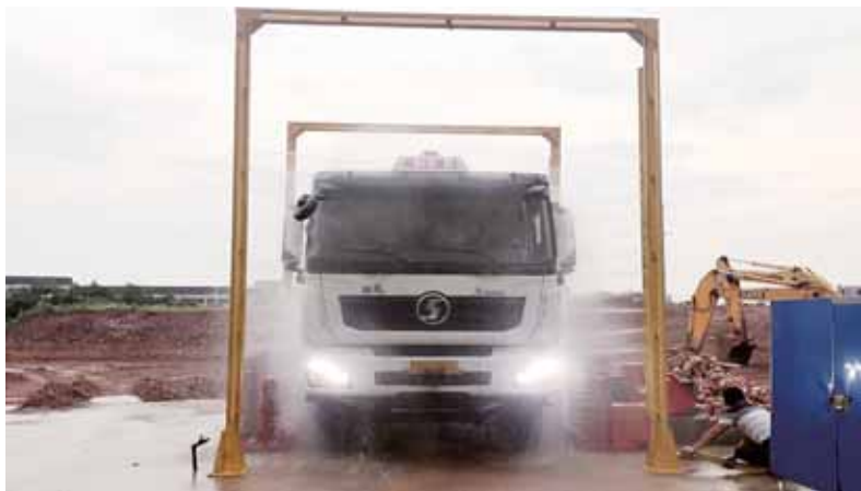
龙门架工程洗车机上线
