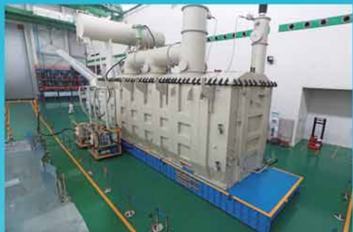
特变电工衡阳变压器有限公司自主研制的首台正负800kV直流换流变压器
