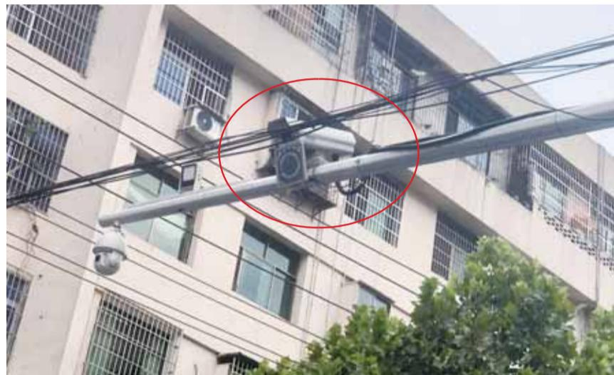
与普通的电子眼不同，“鸣笛抓拍系统”在电子眼下方还安装了一个黑色的小圆盘用于识别鸣笛车辆。
