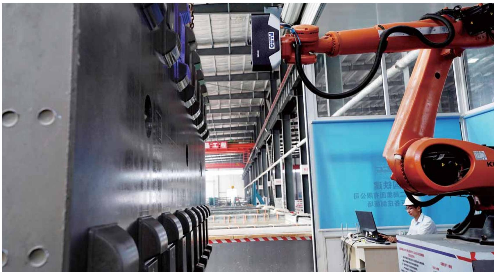
6月17日,一名技术人员通过轨道板自动化检测系统对高铁 CRTS III 型轨道板进行检测。近日,经智能机器人检测合格的第 15000 块高铁 CRTS III 型轨道板在京沈高铁京冀段北京密云巨各庄制板厂下线,标志着我国高铁轨道板自动检测技术达到国际先进水平。
