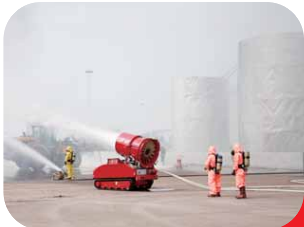
机器人、高喷炮、遥控炮对火灾现场进行强攻灭火
