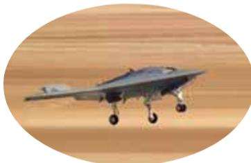
美军X-47B是人类历史上第一架无需人工干预、完全由电脑操纵的“无尾翼、喷气式无人驾驶飞机”,也是第一架能够从航空母舰上起飞并自行回落的隐形无人轰炸机。由美国国防技术公司诺斯罗普·格鲁门公司开发。
