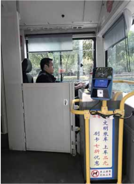
300 多辆营运公交车驾驶室已安装隔离门
