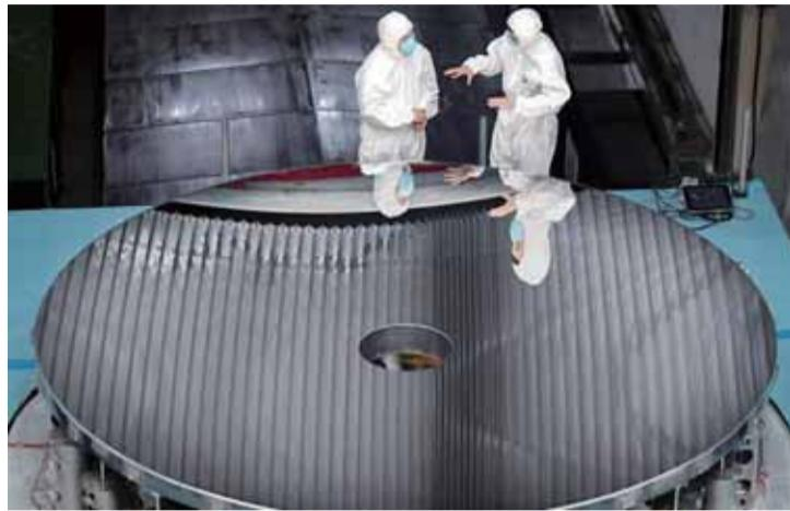
探索9年、经18个月加工“打磨”，一块直径4米、重达1.6吨的“大镜子”21日在中国科学院长春光学精密机械与物理研究所（简称：中科院长春光机所）通过项目验收。这是国家重大科研装备研制项目“4米量级高精度碳化硅非球面反射镜集成制造系统”的最新成果，标志着我国大口径碳化硅非球面光学反射镜制造技术水平已经跻身国际先进行列。
