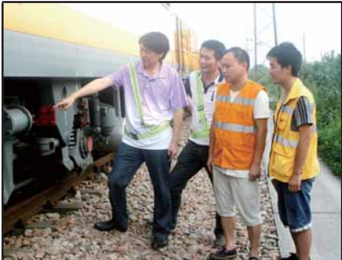
广铁工务大修段各部门利用停工期间,对全段各基地存放车辆、机械设施等进行全面细查,重点整治机车、轨道车走行部“跑、冒、滴、漏”故障。
